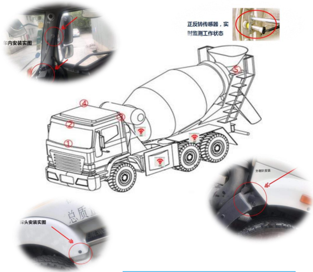
搅拌车作业状态全监管
